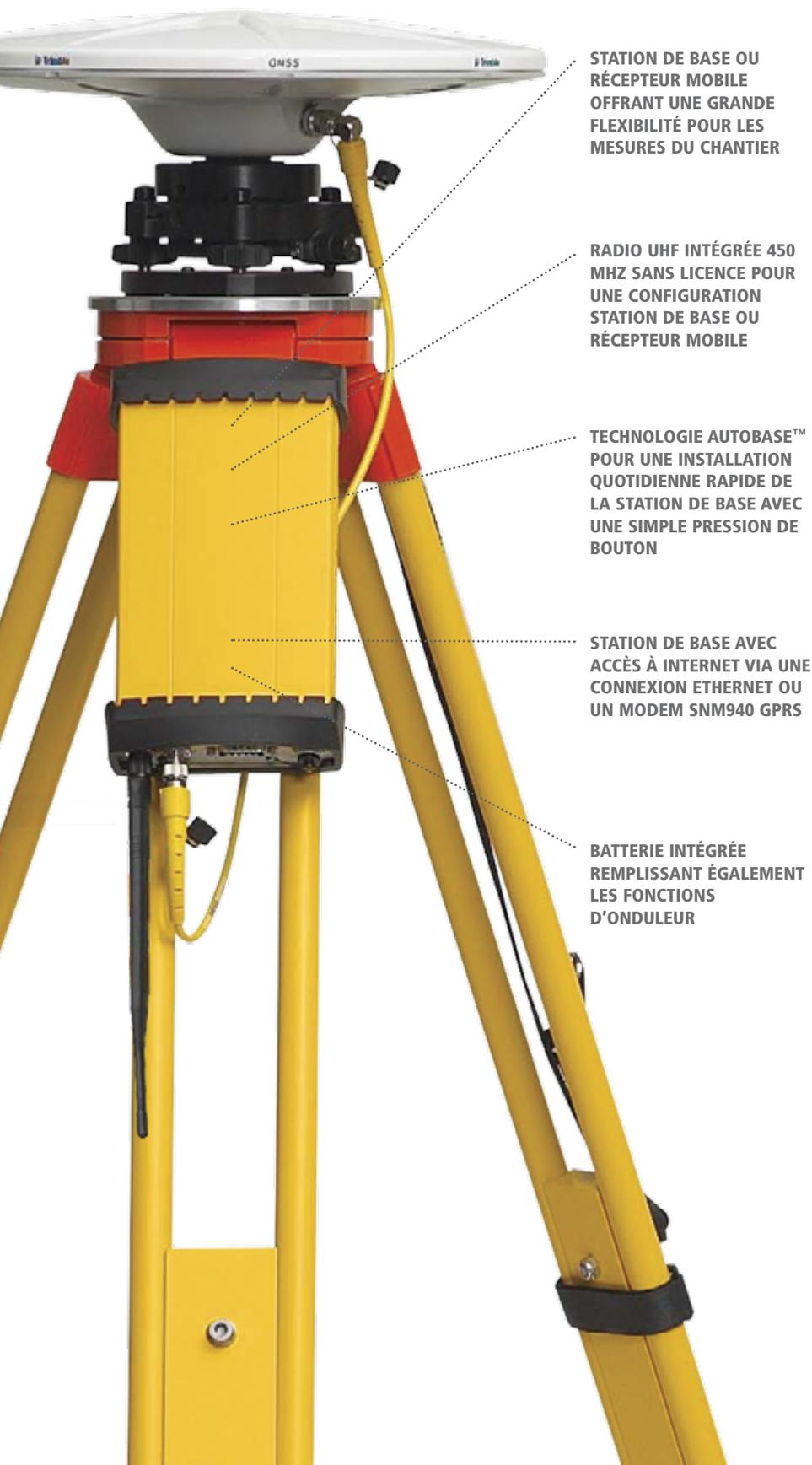
**STATION DE BASE OU RÉCEPTEUR MOBILE OFFRANT UNE GRANDE FLEXIBILITÉ POUR LES MESURES DU CHANTIER**
